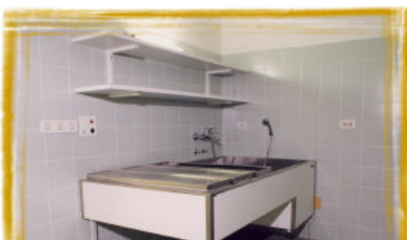
Veliko pomivalno krito z enorocno pipo in tušem za splakovanje predmetov. Primerno za fotografsko delavnico.
