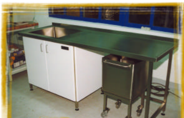
Pomivalno korito s premicnim vozickom in posodo za mokre predmete.
